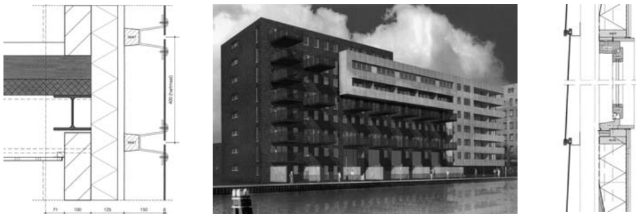
Figuur 1-6 Productinnovatie van een gevel in opeenvolgende projecten door Meyer en Van Schooten: Amstelveens Vertaalburo, appartementencomplex De Steven en Multifunctioneel gebouw Beekpark.
