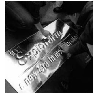
Figuur 22 Het resultaat van explosief omvormen
